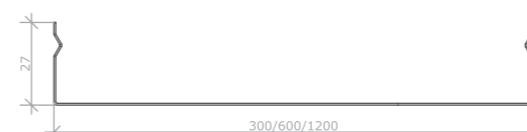
Потолочные панели системы АС крепятся на направляющие (профиль зажимной CLIP-IN BT-600) путём защёлкивания. Система обладает рядом преимуществ:
