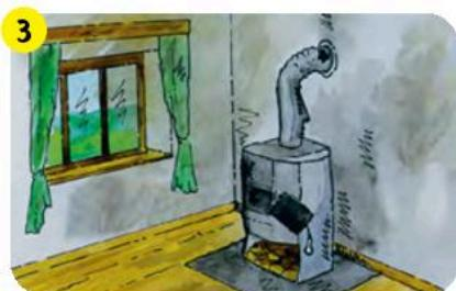
Пол первого этажа с неутепленным цоколем – холодный, что вызывает дискомфорт. Повышается риск появления плесени внутри здания из-за конденсации влаги на внутренней поверхности стены.
