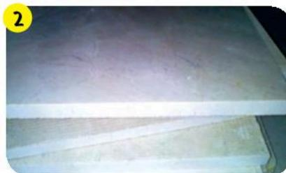
Вес одной плитки может быть более 18 кг, толщина – 11 мм или даже больше.
