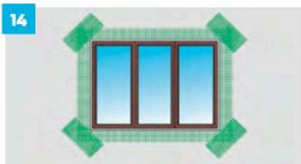
Углы оконных и дверных проемов армировать размещеными по диагонали полосками стекловолоконной сетки размером 200 × 300 мм, которые утапливаются в ранее нанесенный слой клеевого раствора. Дополнительно армировать внешние углы откосов.
