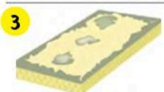
При монтаже теплоизоляции клеевой раствор наносить по периметру плиты и на несколько точек по центру плиты. Площадь приклеивания должна составлять не менее 40 %.
