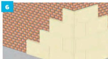
При наклеивании плиты на стену нельзя допускать крестообразных стыков плит и сплошных вертикальных щелей, особенно на углах.
