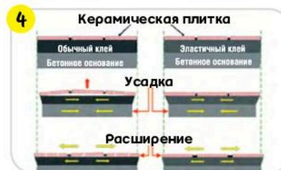
Коэффициенты термического расширения основания и плитки отличаются, это вызывает деформации и напряжения в слое клея, причем тем сильнее, чем больше формат облицовки.
