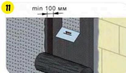
Для создания армированного слоя уложить на поверхность утеплителя полотна стеклосетки, утапливая их в уже нанесенный раствор **weber.therm S100** на глубину примерно 1/3 от толщины слоя с минимальным перекрытием на краях в 100 мм.
