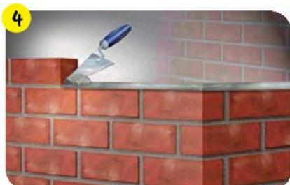
Кладку производить в соответствии с требованиями технического описания раствора, объединенной рабочей инструкции на кладочные растворы и действующими строительными нормативами. Кладочный раствор толщиной шва 10–20 мм наносить на кирпич с помощью стального мастерка. Кладку наружного кирпичного ряда выполнять по полному шву, вдавленному на глубину ≤ 3 мм.
