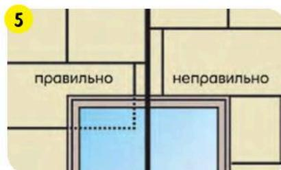
Теплоизоляцию на углы проемов (оконных или дверных) монтировать из цельной плиты, отрезая выступающие части.
