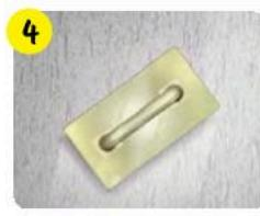
Для создания фактуры сразу после нанесения, не допуская обветривания поверхности, затереть ее пластиковой гладилкой, периодически удаляя излишки связующего с рабочей поверхности пластиковой терки. Эти излишки не следует возвращать обратно в ведро с материалом.
