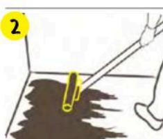
Налейте материал **vetonit PUR coat traffic** на отвердевшее гидроизоляционное покрытие (например, **vetonit PUR seal**) и распределите его на поверхности с помощью резинового валика, сгона или безвоздушным распылением.
