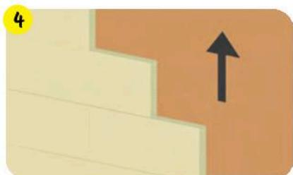
Смонтировать (приклейте) теплоизоляцию снизу вверх, обязательно перевязывая плиты.
