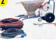
Штукатурную машину подготовить к работе согласно инструкции по эксплуатации. Сухую штукатурную смесь засыпать в приемный бункер штукатурной машины. Установить расход поступающей в насос воды в соответствии с требуемой консистенцией раствора.
