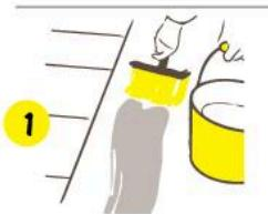
Нанесите **vetonit PUR 1K** валиком или кистью до полного покрытия поверхности. Можно использовать безвоздушный распылитель, что значительно сокращает трудозатраты.
