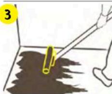
Если вы хотите получить устойчивую к выцветанию, немелящую поверхность, нанесите один или два слоя **vetonit PUR coat** поверх **vetonit PUR entry**.
