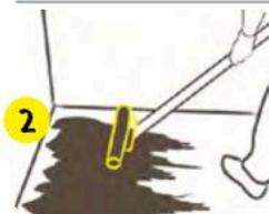
Спустя примерно 1–3 ч (но не позднее чем через 4 ч), пока грунтовка еще немного липкая, нанесите полиуретановое покрытие или полиуретановый герметик для швов.
