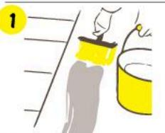
Загрунтуйте поверхности, такие как бетон, цементная стяжка, дерево, битумные листы, металл, керамическая плитка или старые покрытия, с помощью **vetonit EP2K**.
