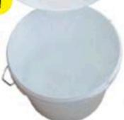
Основание должно быть чистым и твердым. Температура основания и затворенной смеси должна быть не менее +10 °C. Для сплошного шпаклевания мешок (20 кг) сухой смеси высыпать в емкость с 6,4–7,2 л воды, одновременно перемешивая при помощи дрели с насадкой в течение 3–5 мин.
