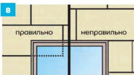
При наклеивании плит на углах проемов не следует допускать сплошных горизонтальных или вертикальных щелей, свисающую часть плиты отрезать.
