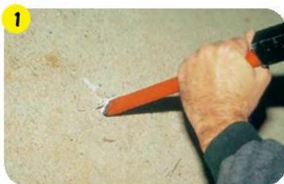
Невысокая прочность бетонного основания требует дополнительного выравнивания для распределения эксплуатационных нагрузок.
